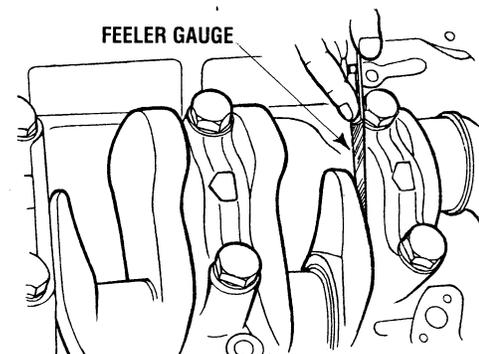
**MEASURE CRANKSHAFT BEARING CAP END PLAY**
