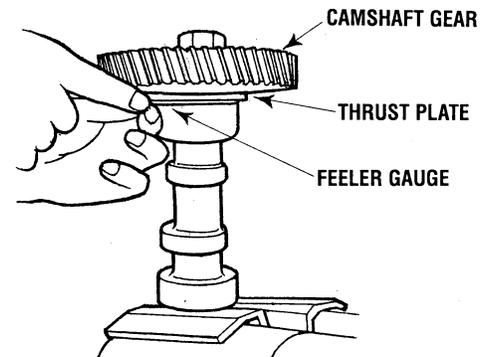
**MEASURE CAM SHAFT GEAR END PLAY**
