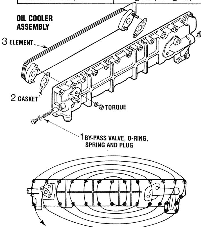
OIL COOLER BOLT TORQUE SEQUENCE
