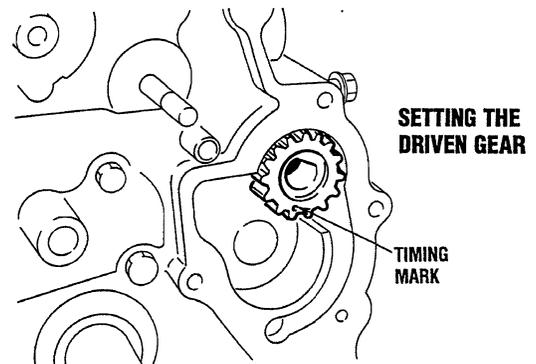
**DRIVEN GEAR FLANGE BOLT TORQUE**
