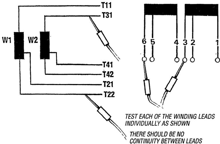
TEST EACH WINDING TO CASE GROUND
