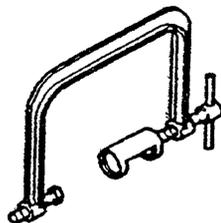
**OIL PUMP OIL SEAL INSTALLER**
