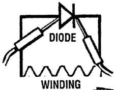
ROTATING FIELD/AUXILIARY WINDING RESISTANCE VALUE
