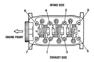
CYLINDER HEAD BOLTS TIGHTENING SEQUENCE
