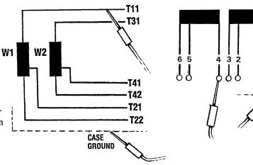
TEST EACH WINDING TO CASE GROUND
